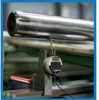
Contrôle automatique de la rectitude
