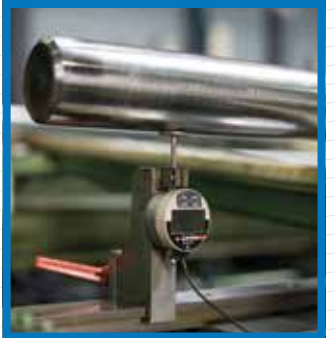
Contrôle automatique de la rectitude
